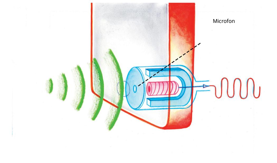
E ondanan di zonido ta core drenta den e microfon y ta cambia den señalnan electrico.
